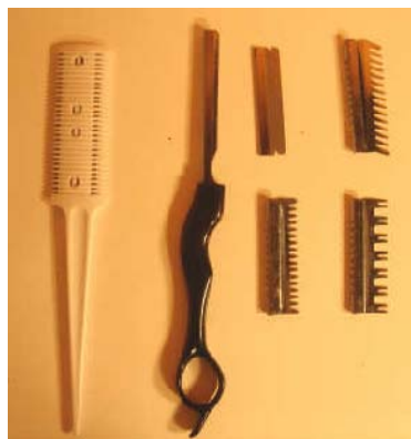
Fig.23. Navaja compacta de un solo cuerpo de hojas recambiables.
