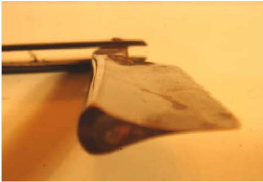
Fig.20. Sección de una navaja. Fig.21. Semi completa (A); Completa (B); Vaciada (C).
